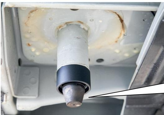
Original Anschlagpuffer eindrücken und z. B. mit einem Draht, das Luftpolster entweichen lassen.
