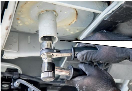
Die Einnietmutter mit einer Einnietzange in die 7mm Bohrung einsetzen.
