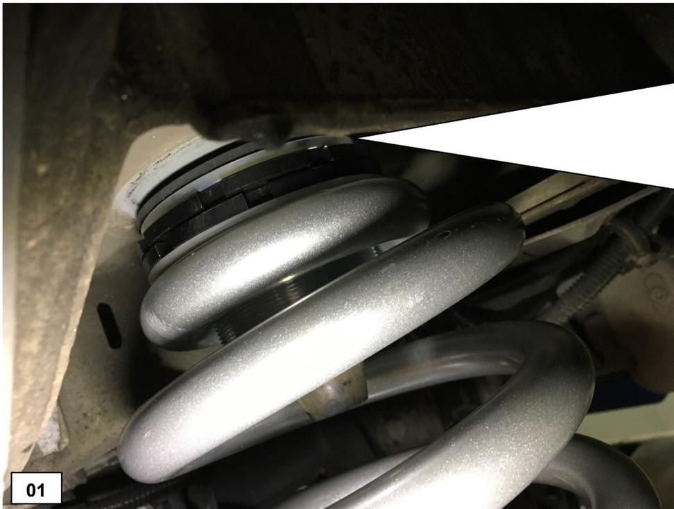
Die Höhenverstellung wird oben montiert u. ersetzt die serienmäßige Federunterlage. Eingestellt ist das minimale Maß! Der max. Verstellbereich beträgt 20mm (siehe Bild 2/3).
